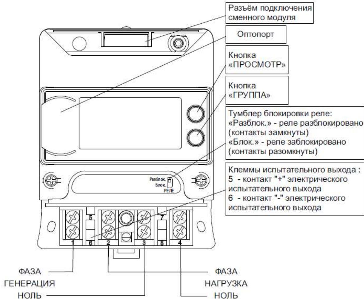
Рисунок Б.2 – Маркировка зажимов и схема подключения счетчика шкафного
