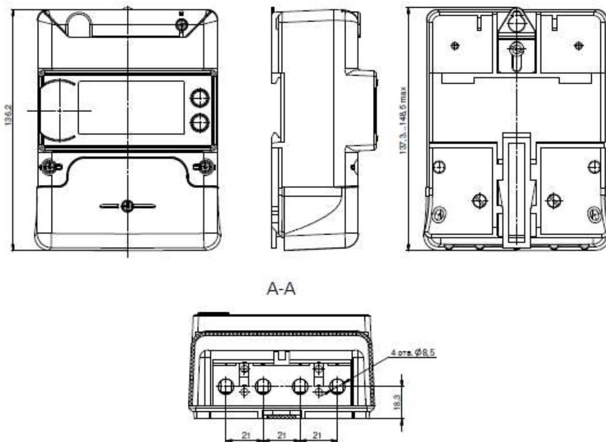
Рисунок А.6 – Габаритные и установочные размеры счетчиков «ФОБОС 1»
