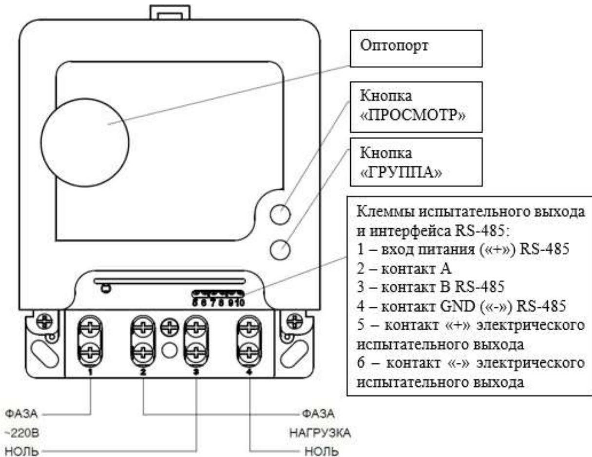
Рисунок Б.1 – Маркировка зажимов и схема подключения счетчика шкафного «базового» исполнения
