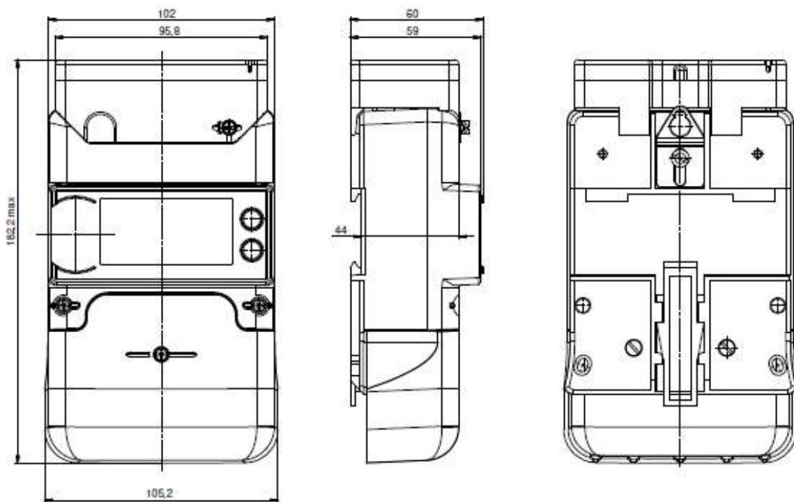
Рисунок А.8 – Габаритные и установочные размеры счетчиков «ФОБОС 1»
