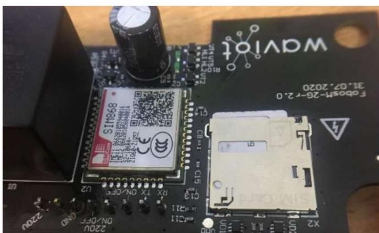
Рисунок 6.2 – Плата сменного модуля связи 2G.
