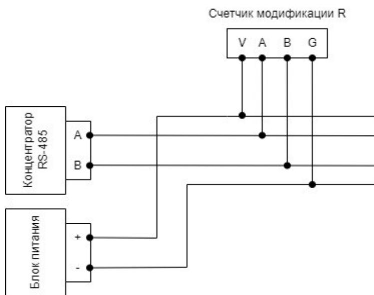
Рисунок 6.7 – схема подключения счетчиков модификации R
