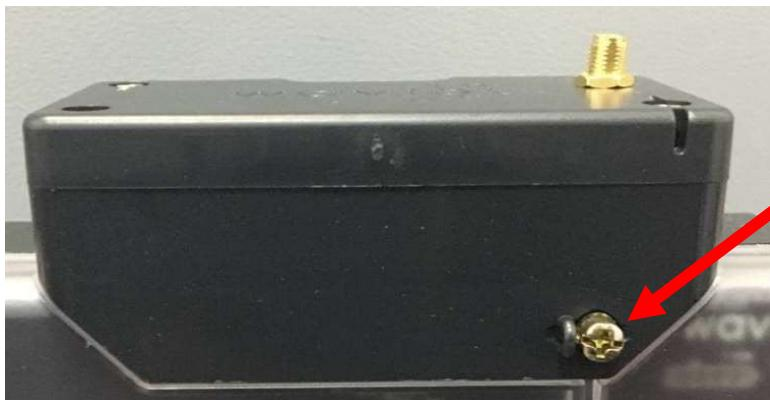
Рисунок 6.4 – винт крепления корпуса модуля связи
