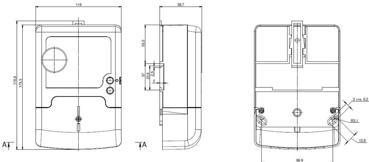
Рисунок А.2 – Габаритные и установочные размеры счетчиков «ФОБОС 1»
