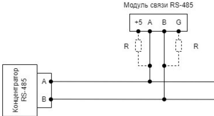
Рисунок 6.8 – схема подключения сменного модуля связи RS-485
