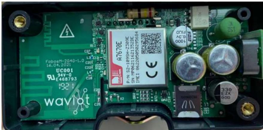
Рисунок 6.3 – Плата сменного модуля связи 2G/4G
